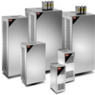
Фильтры гармоник Данфосс специально разработаны для работы с преобразователями частоты Данфосс. Фильтры гармоник Данфосс АНФ 005 и АНФ 010 устанавливаются между питающей сетью и преобразователем частоты и снижают уровень возвращаемых в сеть гармоник тока до 5% и 10% соответственно.
