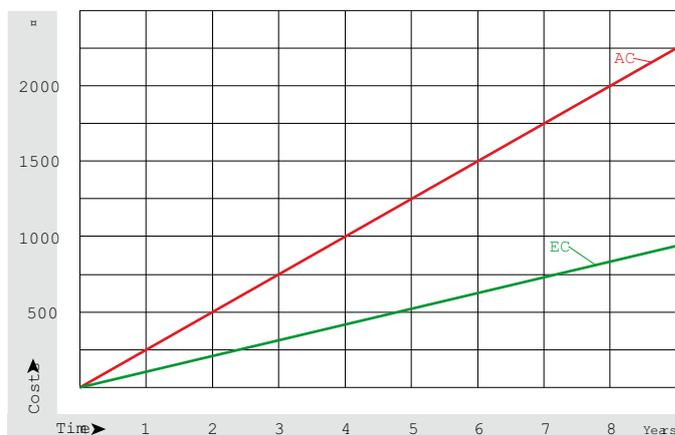
Рис.: Эксплуатационные затраты с течением времени при стоимости 0,10 евро/кВт-ч
