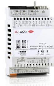
Для связи с модулями расширения используется линия RS485. Подробнее о подключении плат к контроллерам см. параграф «подключение плат расширения».
