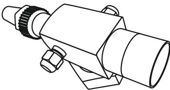
Вентиль «Rotalock» предназначен для запирания и отсечки устройств (компрессоров, ресиверов), что позволяет производить своевременное сервисное обслуживание и облегчает замену оборудования. Два сервисных порта 1/4" SAE предназначены для подсоединения контрольно-измерительного оборудования и автоматики. Материал корпуса — сталь с антикоррозионным покрытием. Все вентили испытаны на прочность и герметичность.
