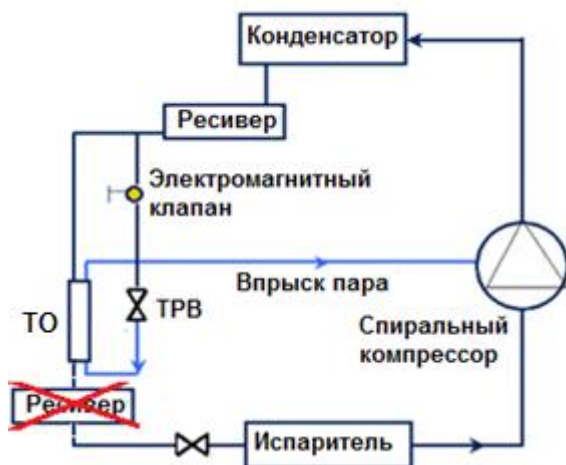
Рис. 12: Правильное и неправильное размещение резерва
