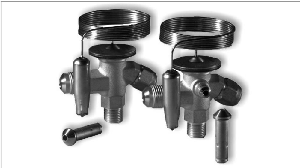
Терморегулирующие расширительные вентили предназначены для автоматического регулирования расхода холодильного агента, поступающего в испаритель холодильной установки, в зависимости от перегрева паров, выходящих из испарителя.
