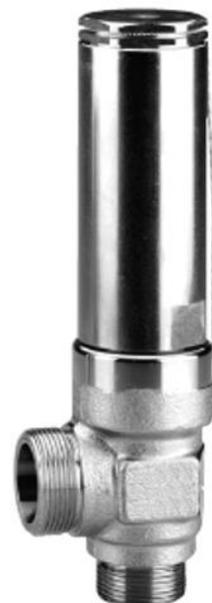
Примечание: давление срабатывания клапана зависит от противодействия, т. е. если давление на выходе и клапана будет выше атмосферного, то давление открытия будет выше заданной уставки срабатывания. При особых обстоятельствах, например вибрации, которая должна быть исключена, и колебаниях давления в системе, разность между рабочим давлением и давлением закрытия может быть больше.
