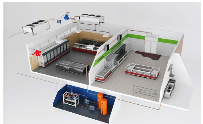
Рис 2. Транскритическая схема на диоксиде углерода для Metro Cash&Carry
